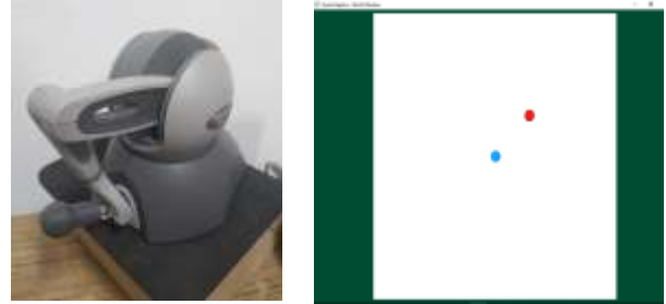
Figura 1. (a) Dispositivo háptico Phantom Omni. (b) Aplicación desarrollada. El círculo celeste está asociado al extremo del robot y debe ser relocalizado en la posición del círculo rojo.
